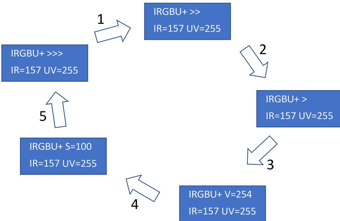
Dopo la modalità > si passa alla modalità **V** (Valore). In questa modalità, ruotando la rotellina (5) in senso ORARIO, il valore V diminuisce, e anche il colore corrente, formato da due colori, pian piano viene portato fino allo spegnimento (V=0). Ruotando (5) in senso ANTIORARIO è possibile tornare pian piano all'intensità iniziale (V=255), ma è anche possibile tornarci
